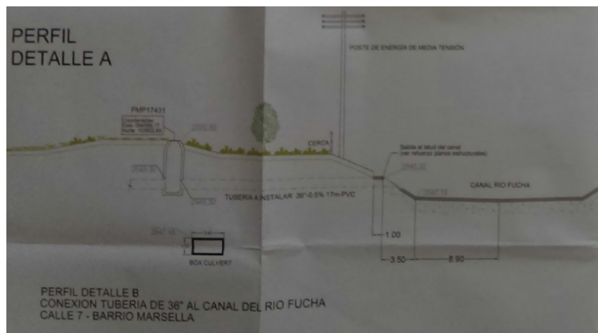
Imagen No. 2. Detalle perfil – Ubicación de la entrega de la tubería de 36”.
